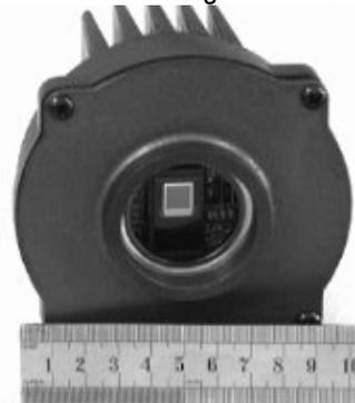
La camera, cioè la parte del sistema che viene collegata al telescopio o all'obiettivo. Al centro è riconoscibile il sensore CCD.
