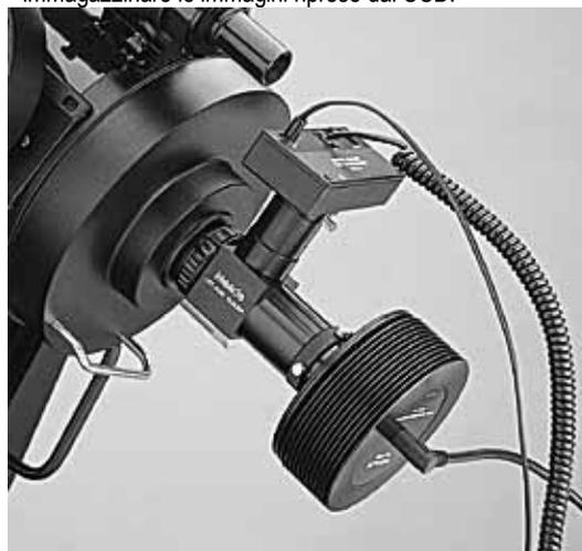
La camera CCD Meade Pictor 416XT, abbinata ad un CCD per l'autoguida Meade Pictor 201XT
