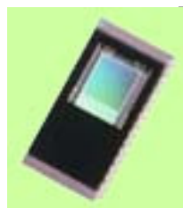
Il CCD Philips FT12: è visibile la finestra ottica che protegge l'area esposta della superficie sensibile.
